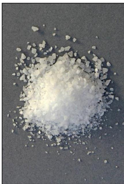
**Formel**  $\text{Al}_2(\text{SO}_4)_3 \cdot 14 \text{H}_2\text{O}$
